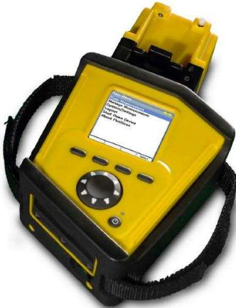
**FluidScan** je ruční systém pro údržbu na základě sledování stavu, který chrání stroj tím, že určí, kdy je potřeba mazivo vyměnit, protože je už znečištěno nebo degradováno. Stanovuje znečištění lubrikantem a degradaci na základě měření klíčových parametrů oleje v mazacích směsích a to jak syntetických tak směsích na bázi ropy.
