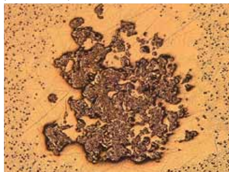
Obr 1: Přeleštěný vzorek s kráterem po předjiskření
