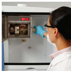
3) Nainstalovat axiální hořák a rozhraní
