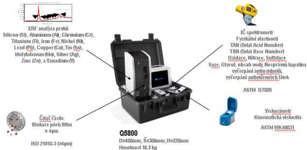
Obr. 5 Schematické znázornění rozmístění jednotlivých modulů přístroje Q 5800
