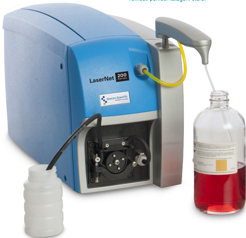
Obrázky otěrů jsou analyzovány a uloženy přímo v SW LaserNet řady 200. Mohou být rozříděny do otěrových tříd. SW OilView™ stanovuje taky počet částic a distribuci velikostí pomocí kategorií otěrů.
