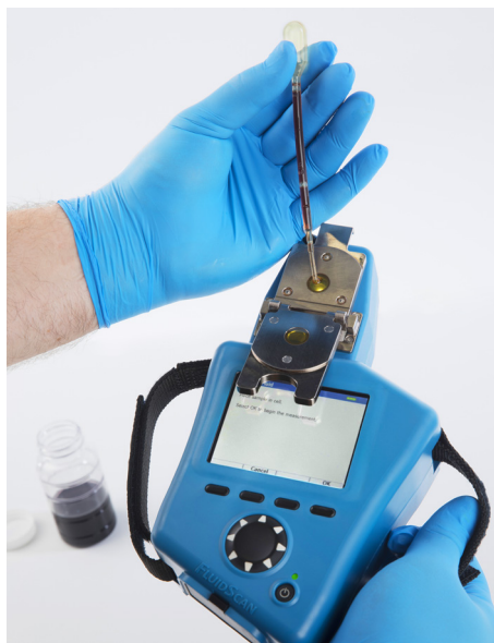
Patentovaná vyklápečí cela pro přesné a jednoduché vzorkování
