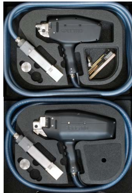
Standardní a UV (vhodná pro analýzu N, C, P, S, Sn, B) měřicí sondy, které je možno připojit během krátkého okamžiku.
