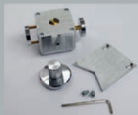
Adaptér pro dráty, šroubky a malé vzorky o průměru 3-10mm
