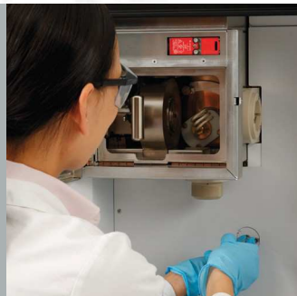
2) Otočit cívku do požadované horizontální pozice
