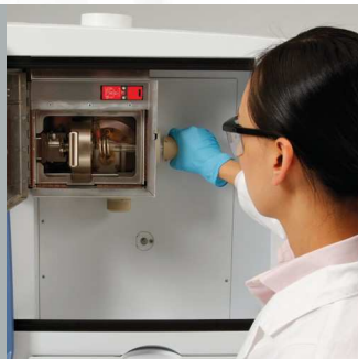
3) Instalovat axiální hořák a rozhraní
