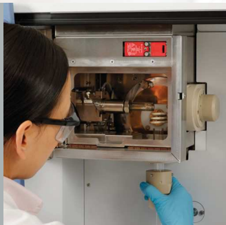
1) Jednoduše vyjmout radiální hořák a rozhraní
