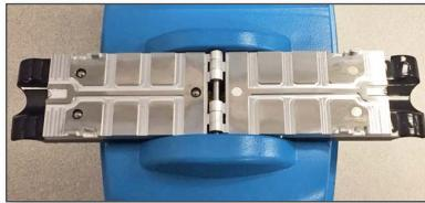
Otevření dvou paralelních desek pro jednoduché čištění.
