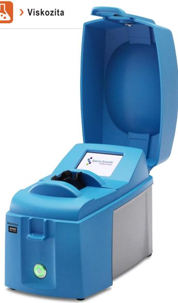
U strojních olejů je 40°C kinematická viskozita použita jako referenční hodnota. Motorové oleje pracují při vyšších teplotách než rotační stroje, vyžadují tedy V100°C kinematickou viskozitu. Index viskozity olejů je parametr, který vztahuje V40°C naměřenou hodnotu na V100°C hodnotu. Hodnota referenčního indexu viskozity se může vložit do viskozimetru a hodnoty obou - změřené viskozity V40°C a vypočtené viskozity V100°C jsou zobrazeny.
